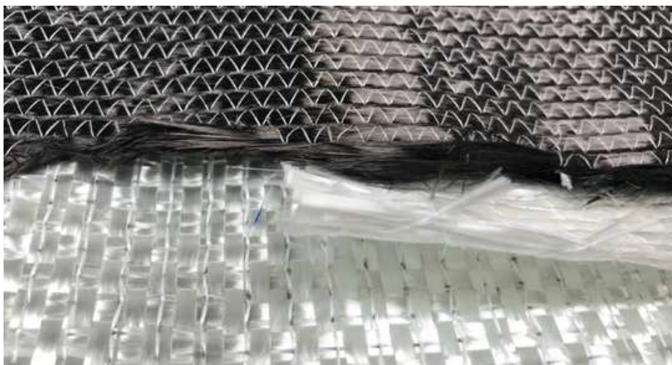
Glasfasern und Kohlefasern werden bei KK Composites auch kombiniert. Bild: KK Composites GmbH
